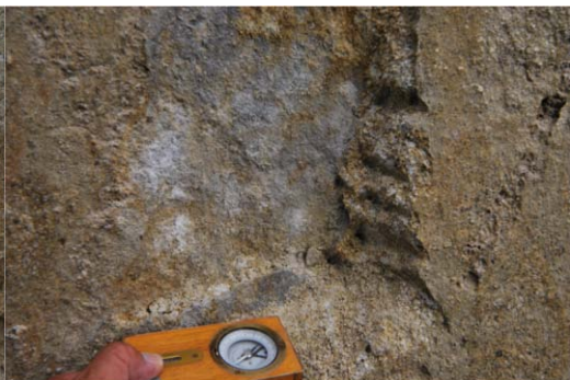
古い開口割れ目は、み込んだ粘土が充填している
