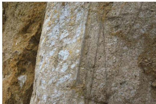
古い開口割れ目は、み込んだ粘土が充填している
